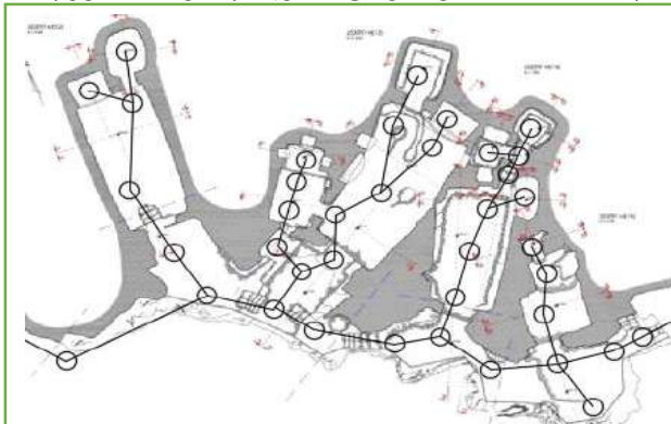
სურ. 2 სკანერის დგომების სტრუქტურული სქემა
