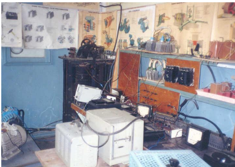
Рис. П.6. Общий вид измерительного стенда и силового регулировочного трансформатора
