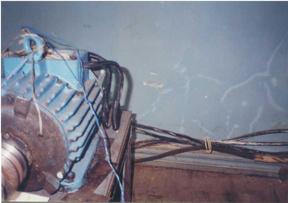
Рис. П.5. Генератор на базе двигателя МТО12-6
