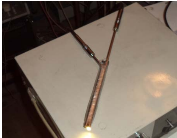
ნახ.1, ნახ. 2. მოქმედი ექსპერიმენტული დანადგარი და ოპტიკურ-ბოჭკოვანი სენსორი ორი არხით.
