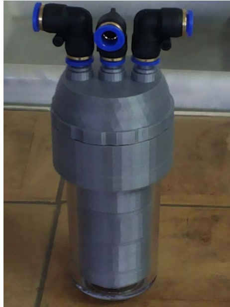
სურ.1 წყლიდან 300მკმ-დან 50მკმ-მდე ზომის ნაწილაკების შემაკავებელი ხელსაწყო
